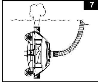
8. Avviare la pompa filtro e assicurarsi che l'acqua scorra attraverso il micro-filtro (6) e l'adattatore del tubo (7). A questo punto il pulitore incomincia a muoversi e aspirare il fondo della piscina. Vedi fig. 8. **Nota:** La pompa filtro a cartuccia e la pompa filtro a sabbia puliranno l'acqua della piscina. È essenziale pulire o sostituire la cartuccia del filtro o controllarne il filtro a sabbia frequentemente per mantenere l'acqua pulita.
