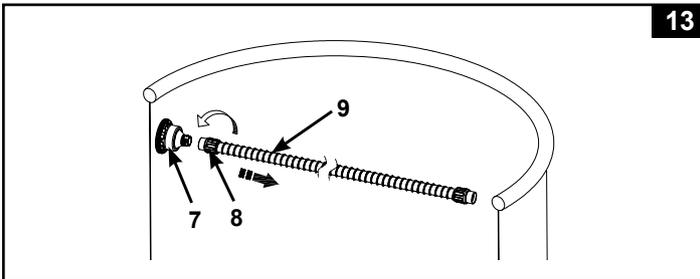
3. Svitare (in senso antiorario) l'adattatore del tubo (7) dal connettore filettato del filtro. Rimuovere il micro-filtro (6) dall'adattatore del tubo. Usare un tubo da giardino per pulire e rimuovere eventuali detriti dal micro-filtro e dall'adattatore del tubo. Vedi fig. 14.
