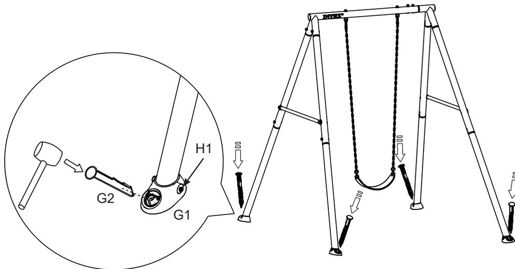
1. Basi di ancoraggio in calcestruzzo (non incluse). Livellare l'altalena e contrassegnare le posizioni dei piedi di ancoraggio. Scavare delle buche di 30 cm di diametro e 35 cm di profondità.
